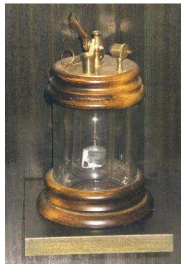
Abb.23. Nachbau des Döbereiner Feuerzeugs
