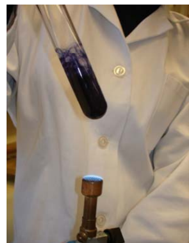
Abb.74.b. Erwärmung der Flüssigkeit: das ursprüngliche Blau kommt wieder zum Vorschein
