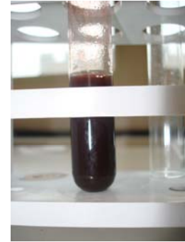
Abb.71.c. Violette Färbung beim Vermengen von \text{K}_4\text{Fe}(\text{CN})_6 und \text{CuCl}_2
