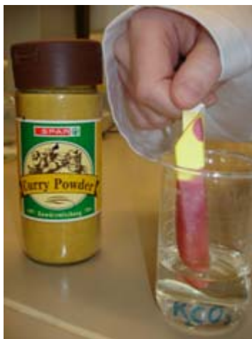
Abb.73. Mit Curcumin getränktes Filterpapier in Kaliumcarbonat-Lösung
